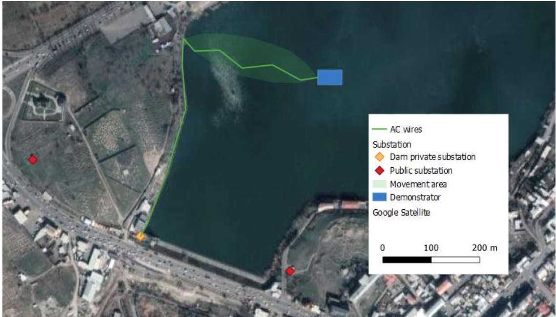
Նկար 6. Մինչև ամբարտակի ենթակայանը լաստերի և ջրհեռի վրա ֆիքսված մալուխների դասավորությունը
